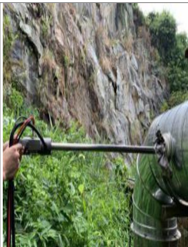
生产车间废气处理前检测口 ◎Q1
