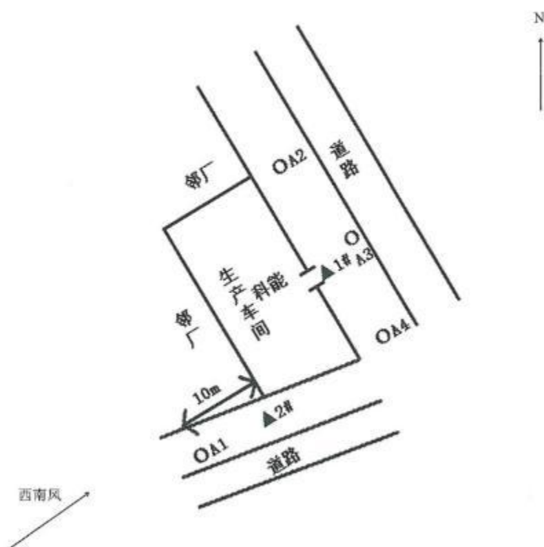
图 8.1 无组织废气、噪声检测点位示意图 (○表示无组织废气检测点位、▲表示噪声检测点位)
