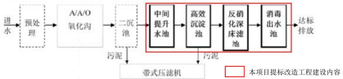
图 3-1 提标改造后工艺流程图
