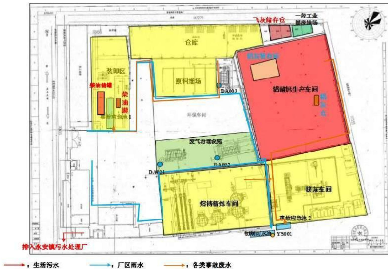
图4-5 雨水、污水及各类事故废水走向图
