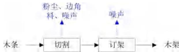
图 3.4-9 包装框架制作工艺流程图
