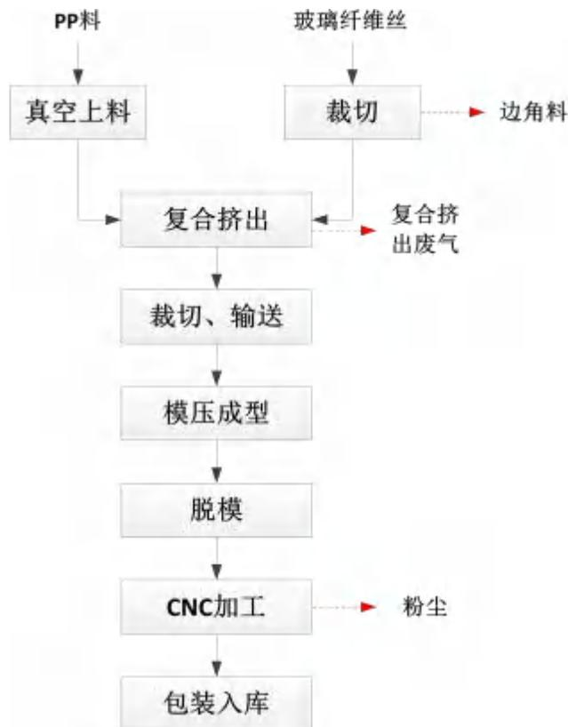
图 2.2-1 LFT-D 产品工艺流程及产污环节图
