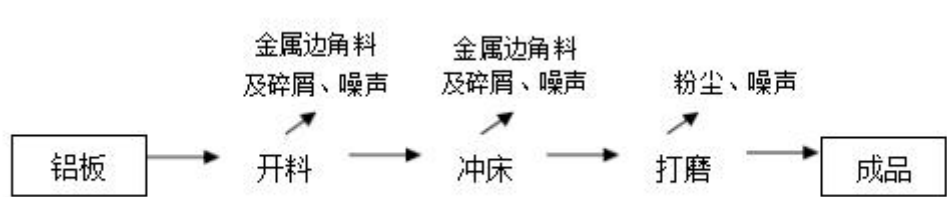
图 3-3 铝单板生产工艺流程图
