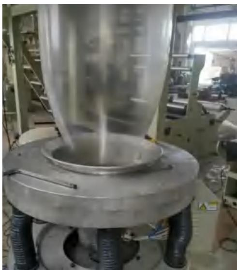
薄膜到达顶部的收卷单元前的状态为双层薄膜（宽约 1.75m），通过第一级收卷单元初步收卷，后续收卷单元再切割、展开为单层薄膜。吹出过程会产生有机废气。
